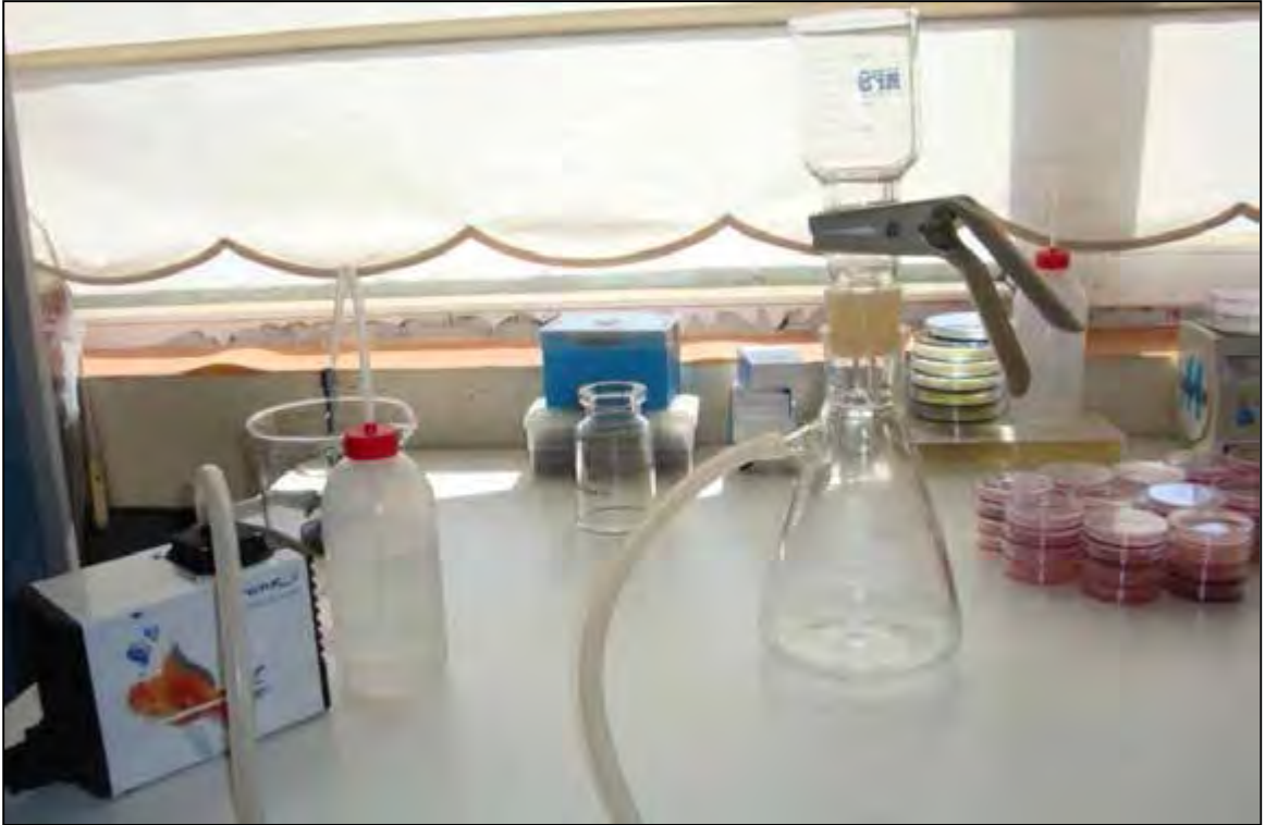
Şekil 5.4. Membran filtrasyon yönteminde kullanılan vakum sistemi
