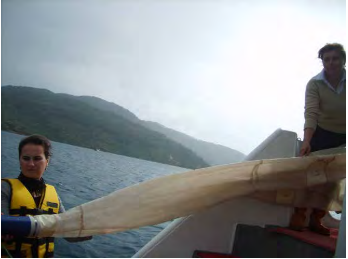
Şekil 3.23. WP2 Unesco standart plankton kepçesi (Fotoğraf: Mukbil GÜLKOKAN)
